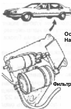
Рис. 5.86 Расположение элементов топливной системы — модель 960
