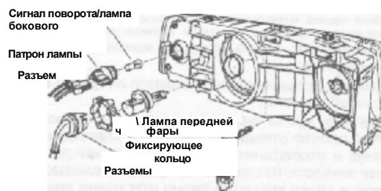
Рис. 6.36 Замена лампы передней фары. Модели с передними противотуманными лампами — показано для 740 и 900 Серии, для других то же самое
