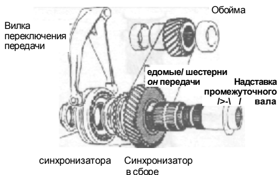
Рис. 7.15 Элементы пятой передачи коробки передач М47
