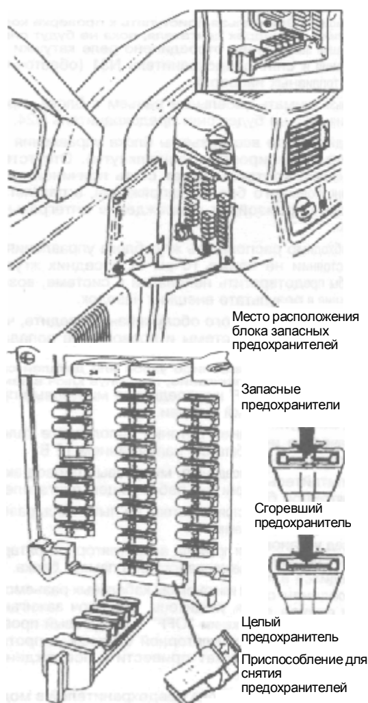
Рис. 5.71 Расположение блока предохранителей — крайняя левая сторона панели приборов — Volvo-960
