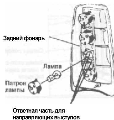
Рис. 6.40 Замена ламп заднего фонаря — показано для Универсала 240 Сери
