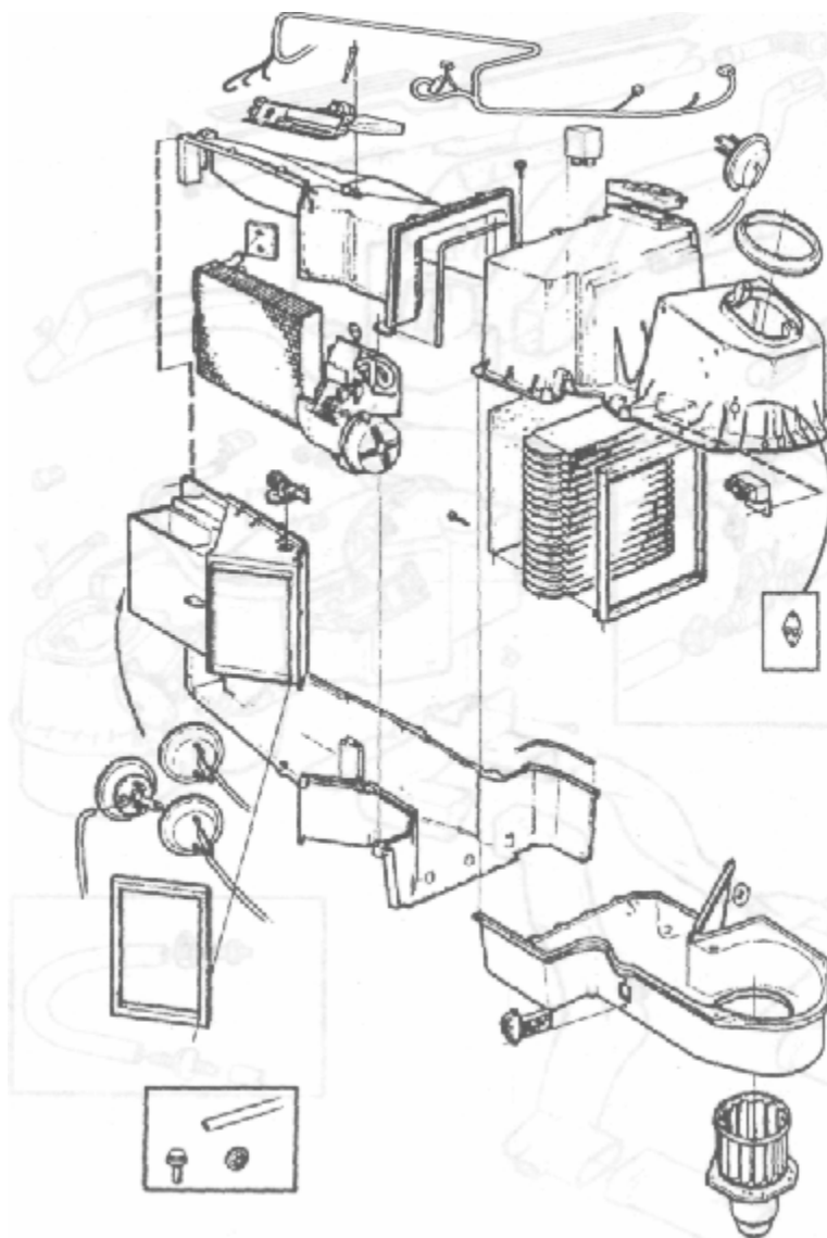
Рис. 6.10 Радиатор отопителя в сборе с автоматическим кондиционером (ACC) — 700 и 900 серии
