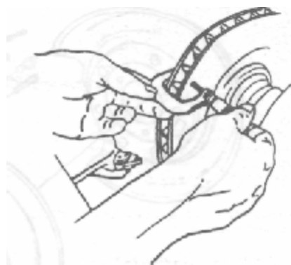
Рис. 9.15 Для измерения толщины тормозного диска пользуйтесь микрометром
