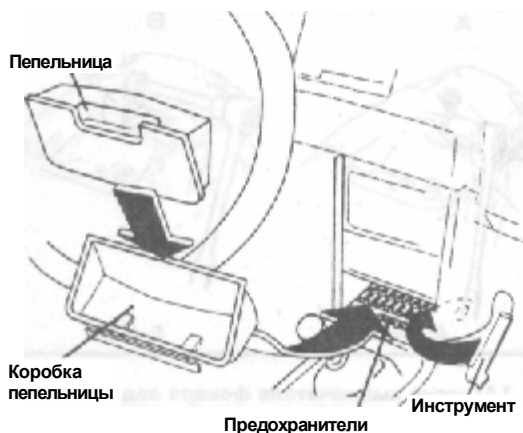
Рис. 6.51 Расположение коробки предохранителей • 940 модель
