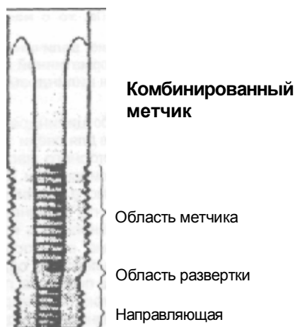
Рис. 3.9 Восстановление резьб свечей зажигания Глубина резьбы
