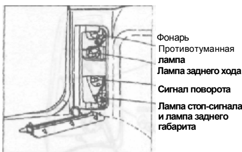
Рис. 6.42 Замена ламп заднего фонаря — показано для Универсала 740 и 900 Серии
