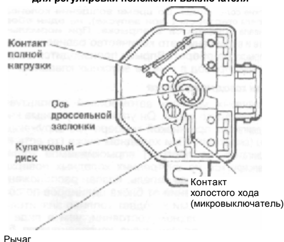
Рис. 5.3 Выключатель дроссельной заслонки — LH-Jetronic
