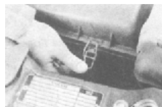
Рис. 1.9 Отстегните удерживающие половинки корпуса воздушного фильтра застёжки -показан двигатель с турбонагнетателем
