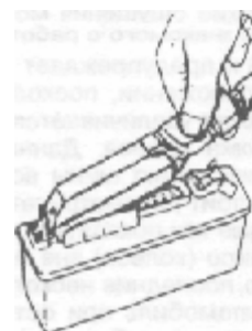
Рис. 9.31 Снимите проводку блока управления, нажав на стопорную пружину и достав разъем из его крепления
